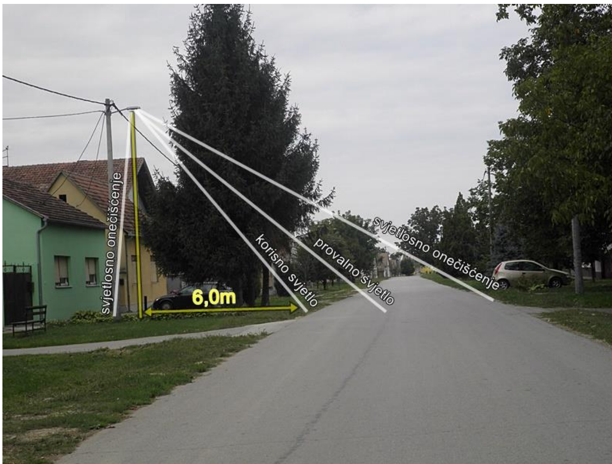
Prikaz rasvjetljenosti u ulici Ante Starčevića u Lovasu, klasa rasvjete ME5 – primjer loše prakse
